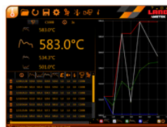
L'affichage Tableau présentant les lectures de température instantanée, basse, moyenne et haute, plus la température Meltmaster exclusive (sur le modèle 055 L).
