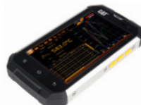
L'affichage Tableau présentant les lectures de température instantanée, basse, moyenne et haute, plus la température Meltmaster exclusive (sur le modèle 055 L).
