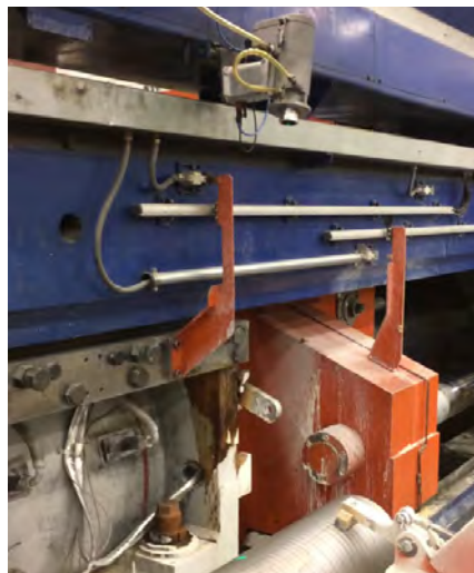
SPOT AL EQS et actionneur balayant un profilé le long de la billette arrivant à la presse
